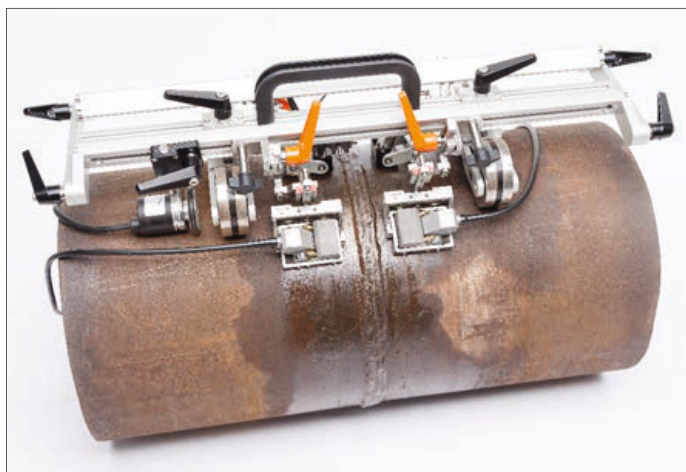
Сканнер для ручного исследования стыковых и кольцевых сварных швов с позиционным кодировщиком, магнитными колесами и каретками для 2-х датчиков ФАР и TOFD
